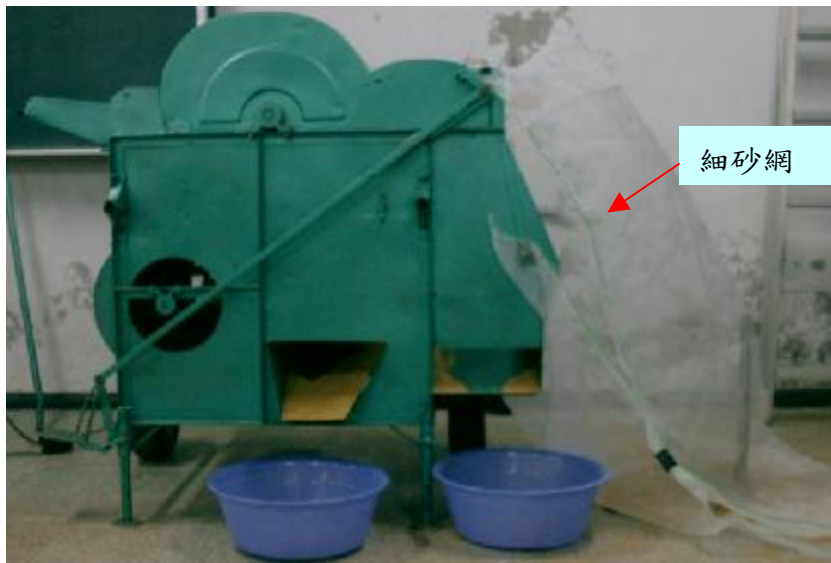
圖 4-6 小米脫粒機排塵口包細網
