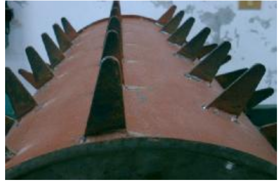
圖 3-6 小米脫粒機脫穀齒(螺旋式排列)
